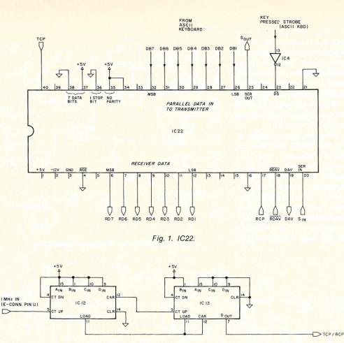
Fig. 2. 300-baud clock circuit.
